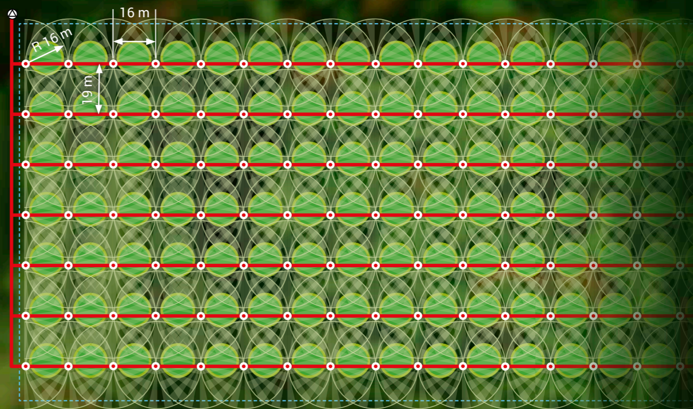
Przykładowy schemat nawadniania sadu przy użyciu zraszaczy pełnობrotowych ZB22
