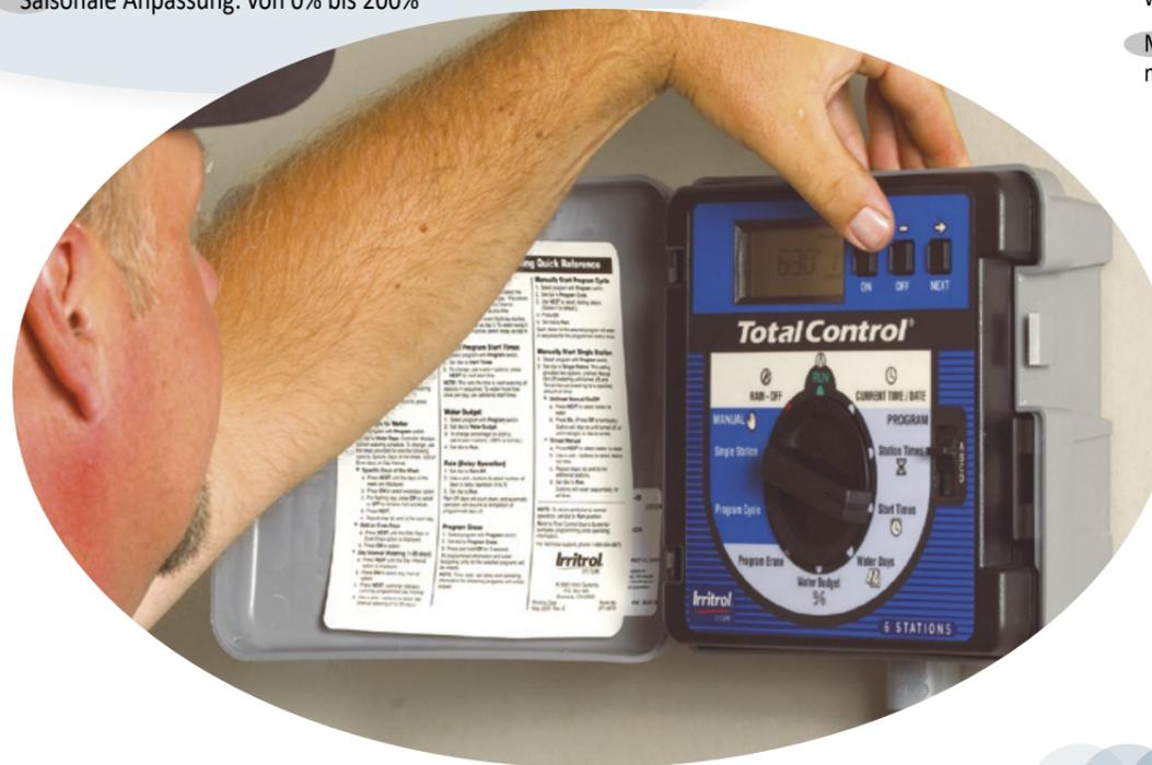
**T**otal Control ist das Irritrol-Steuerggerät für die Bewässerung von großen Gärten und Parks, an das bis zu 48 Stationen angeschlossen werden können. Seine Flexibilität ermöglicht es, bis zu 16 tägliche Startzeiten zu programmieren; und dank des großen Displays und des zentralen Drehknopfes ist die Programmierung auch für Systeme mit vielen Stationen einfach und schnell.
